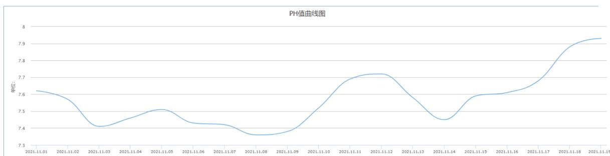
图 3.5.1-2 杭电化排放口 pH 监控数据曲线图 (pH 标准限值 6~9)
